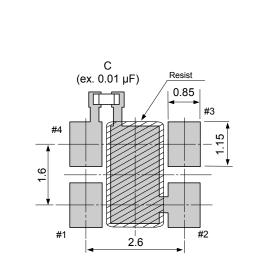
为了维持稳定运行,在接近晶体产品的电源输入端处(在VCC-GND之间)添加一个0.01~0.1uF的去耦电容。
